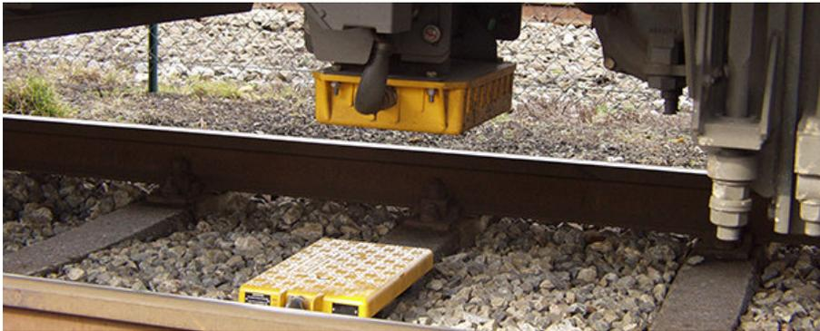
Abb. 3 Balisensystem. Die Zugposition wird bei Überfahrt der Balise an den Zug übertragen
