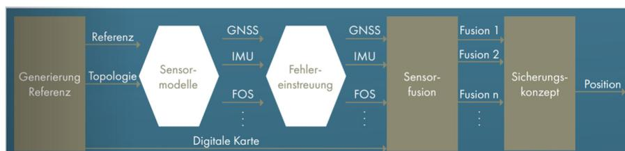
Abb. 10 Für beliebige Strecken und Zugkompositionen werden virtuelle Referenzfahrten generiert, die als Eingang für detaillierte Sensormodelle dienen. Simulationsergebnisse können als essentieller Bestandteil zum Nachweis der funktionalen Sicherheit dienen[11].
