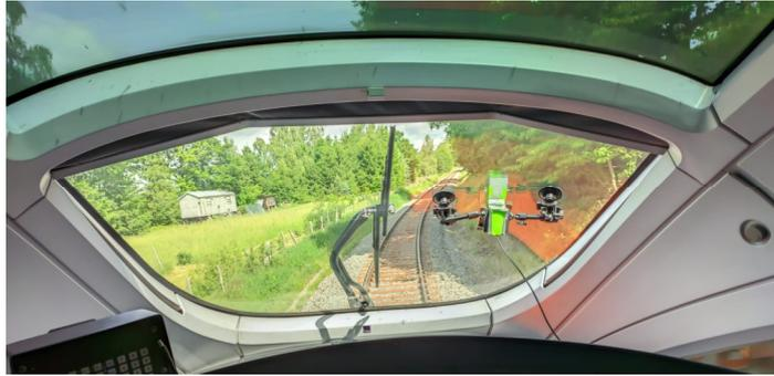
Abb. 5 Auf das Gleis gerichtetes Kamerasystem zur Zuglokalisierung
